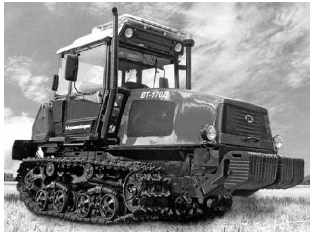
Рис. 2. Трактор ВТ-170Д с капотом каркасно-панельной конструкции
